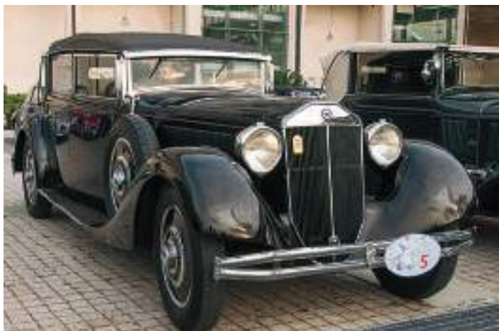
Nel 1932 la Dilambda firmata Gangloff Geneve, grazie alla robustezza del telaio, risolve le difficili criticità strutturali delle carrozzerie cabriolet a quattro porte. A destra, fedele alla costruzione con il sistema Weymann, questa berlina sport dell'inglese H.J. Mulliner mostra la particolarità delle pedane singole.
