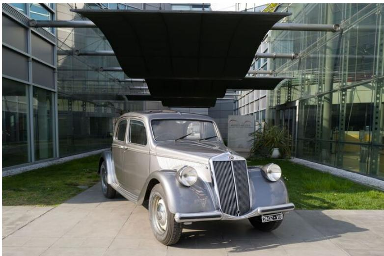
La carrozzeria presenta le caratteristiche portiere ad armadio senza montante centrale e la raffinata meccanica vanta le sospensioni indipendenti anche al retrotreno. Un particolare originale della vettura del Museo è rappresentato dai due tettucci apribili, separati tra loro, che le hanno valso la nomea di "auto dei gangster". In realtà questa era una soluzione tecnica dovuta alla conformazione della carrozzeria stessa.
