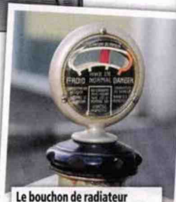
Le bouchon de radiateur intègre un thermomètre rudimentaire permettant au conducteur de contrôler aisément la température d'eau.
