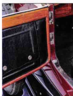
L'élégance de la Diatto se retrouve partout : l'intérieur de la capote est vierge de tout élément structurel, hormis un renfort transversal peint dans la couleur de la toile.
