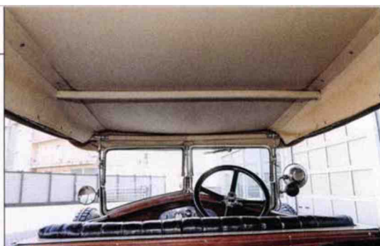
L'élégance de la Diatto se retrouve partout : l'intérieur de la capote est vierge de tout élément structurel, hormis un renfort transversal peint dans la couleur de la toile.
